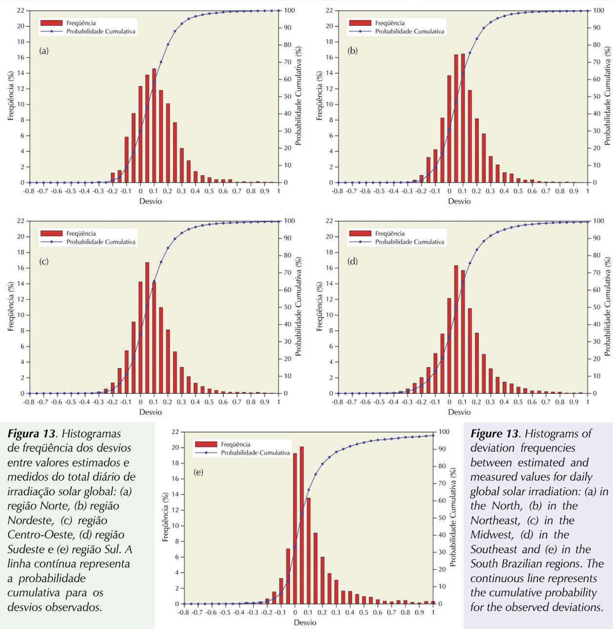
**Figura 13.** Histogramas de frequência dos desvios entre valores estimados e medidos do total diário de irradiação solar global: (a) região Norte, (b) região Nordeste, (c) região Centro-Oeste, (d) região Sudeste e (e) região Sul. A linha contínua representa a probabilidade cumulativa para os desvios observados.
