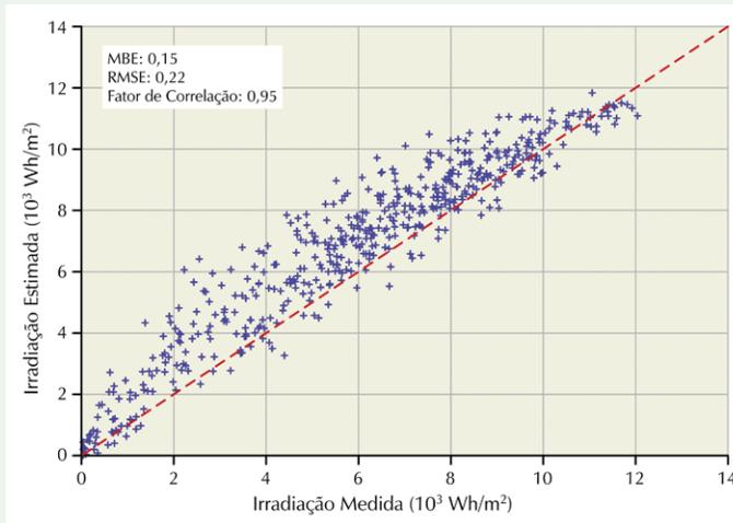
**Figura 14.** Gráfico de dispersão entre valores medidos e estimados da irradiação direta e o histograma dos desvios observados. Os pontos representam os dados das 3 estações SONDA apresentadas na Tabela 4.
