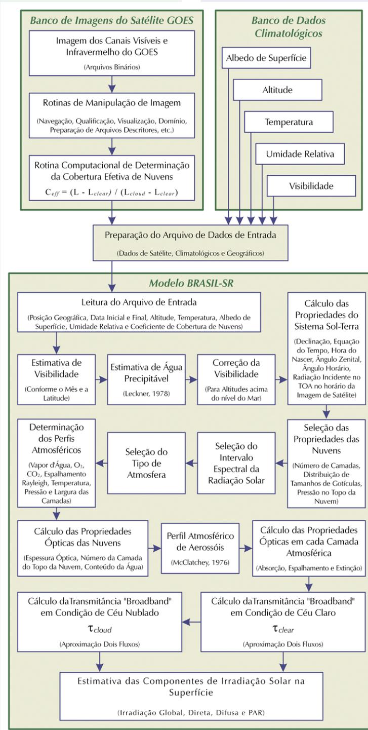
Figura 4. Fluxograma do modelo de transferência radiativa BRASIL-SR.
