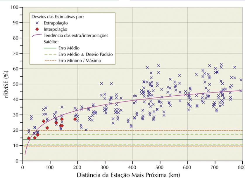
**Figura 2.** Comparação dos desvios rRMSE das estimativas de radiação global obtidas por extra/interpolação de dados coletados em 16 PCDs da região sudeste e estimativas do modelo BRASIL-SR baseadas em imagens de satélite. A linha magenta representa a curva de tendência dos desvios das estimativas por extra/interpolação em função da distância à PCD mais próxima. As linhas horizontais representam o intervalo dos desvios de estimativas fornecidas pelo modelo BRASIL-SR.
