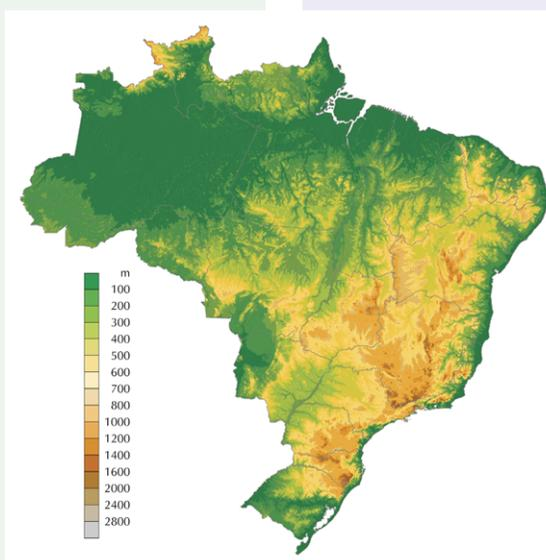
**Figura 10.** Imagem de relevo gerada por interpolação (vizinho mais próximo) da base de dados GTOPO30.
