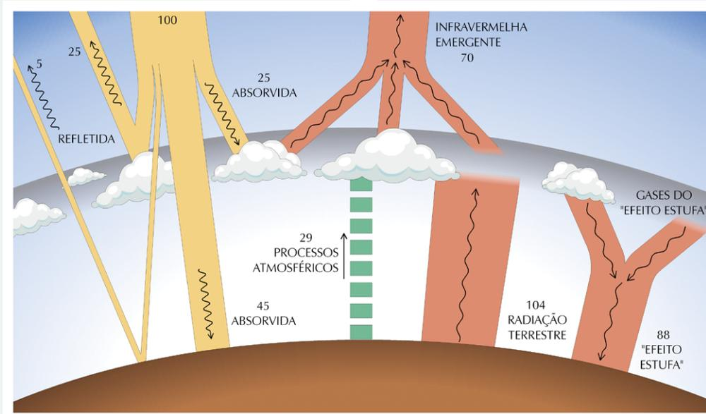
**Figura 3.** Diagrama simbólico dos processos de interação da radiação solar com a atmosfera terrestre. Os valores numéricos representam a fração de energia em cada processo radiativo na atmosfera. Modificado a partir de Gambi [11].
