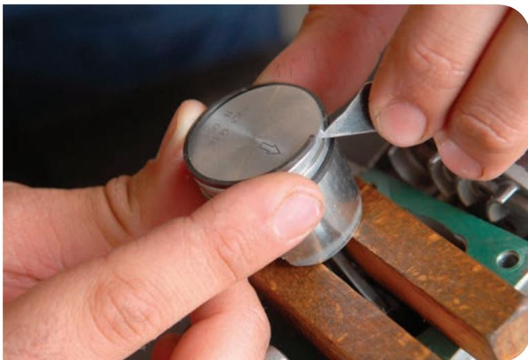
a) Coloque uma extremidade do anel superior na cabeça do pistão, girando-o até que se solte.
