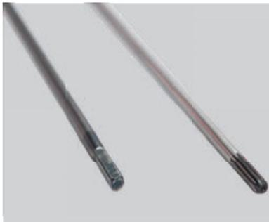
Ao fazer a montagem do eixo cardã com ponta estriada, é necessário invertê-lo, prevenindo o desgaste prematuro. No eixo cardã com ponta quadrada, não se aplica essa inversão.
