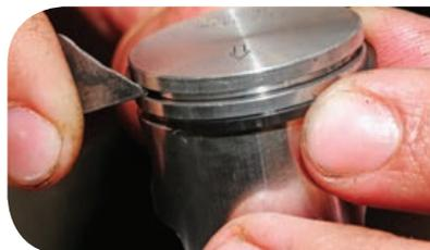
c) Repita o procedimento com o segundo anel, até que se encaixe por completo, na canaleta superior; e
