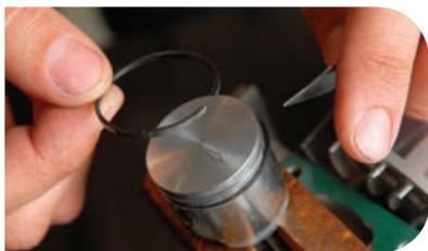
b) Coloque uma extremidade do anel inferior na canaleta superior, girando-o até que se encaixe por completo na canaleta superior.
