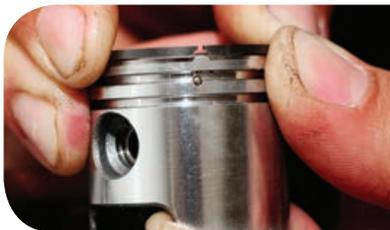
**6.10.3 Descarbone as canaletas do pistão e a parte interna dos anéis com um pedaço de serra**
