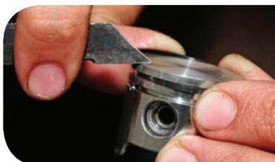
b) Coloque o segundo anel na canaleta superior, girando-o até se encaixar por completo;
