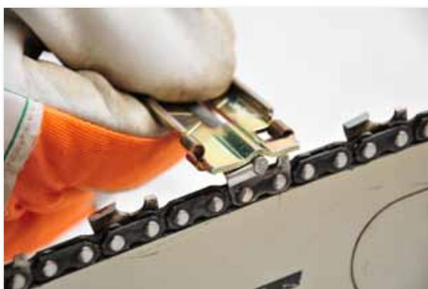
Em relação ao dente de corte a profundidade deve ser de tal forma que 1/5 do diâmetro da lima fique acima da superfície do dente, para que não haja deformação na aresta de corte.
