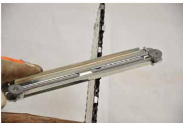
Este ângulo determina a capacidade de corte, fazendo com que o dente corte a madeira com o mínimo esforço. O ângulo pode variar de 25 a 35 graus, devendo ser consultado o manual do operador.
