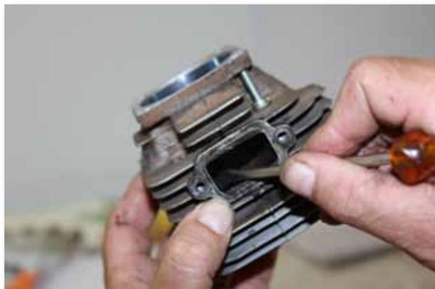
Limpe o “fundo” da parte interna do cilindro utilizando uma chave de fenda para retirar o “carvão impregnado”. Na parte externa, limpe a saída para o escapamento.
