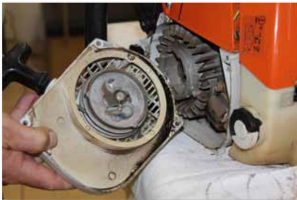
A tampa do arranque cede à passagem de ar para arrefecer o motor, trazendo além do ar muitos resíduos. A limpeza é fundamental para uma boa ventilação do motor. Deve ser realizada utilizando querosene ou gasolina.
