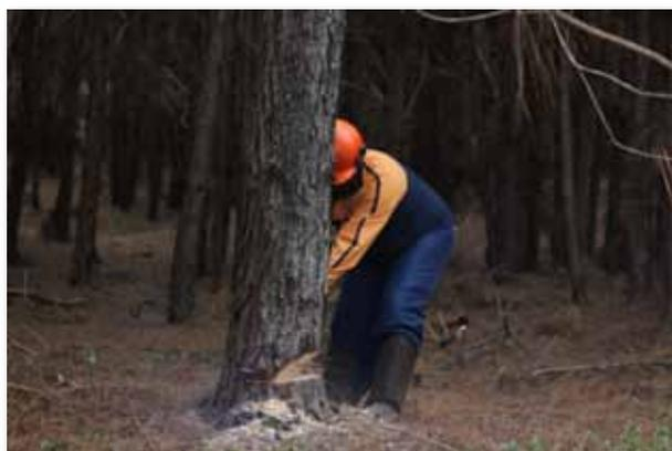
Quando o diâmetro da árvore for superior ao comprimento do sabre, este corte será feito em etapas, sempre respeitando o filete de ruptura.
