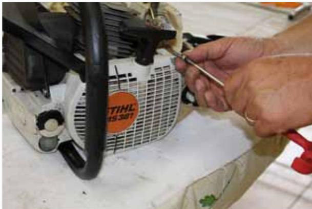
**5.10. Retire os parafusos do escapamento**
