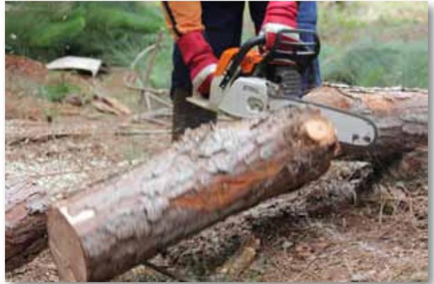
Quando está apoiado nas duas pontas, inicia-se com um pequeno corte pela face superior e conclui-se o corte pela face inferior.
