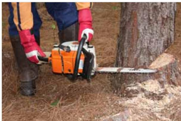
Este corte é realizado visando à prevenção de rachaduras laterais no fuste.
