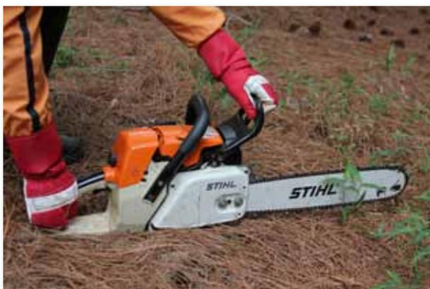
**11.7. Segure firmemente, com a mão esquerda, o punho dianteiro da motosserra**
