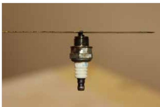
O calibre normalmente é de 0,5 mm (consulte o manual do fabricante) e, para a calibragem, utilize um jogo de chaves específico ou uma folha de serra ferro (serrinha).
