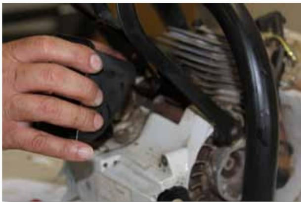
**5.14. Retire o cabo de empunhadura esquerdo**
