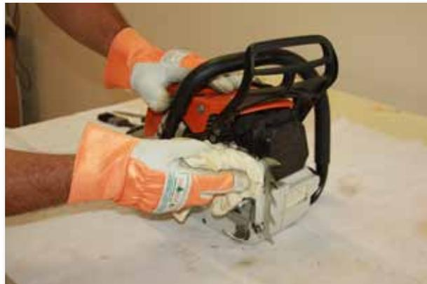
A limpeza deve ser feita com um pincel ou pano, utilizando querosene ou gasolina.
