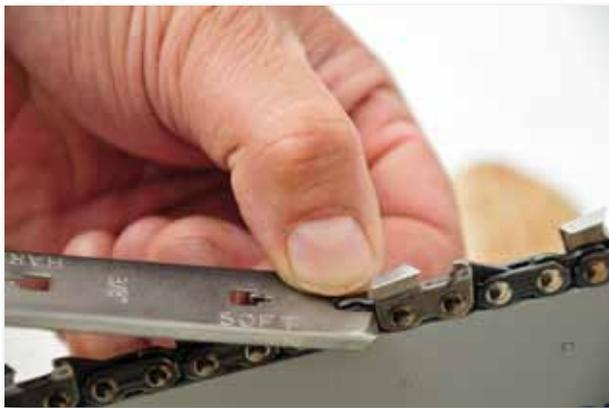
A guia no dente de corte tem a finalidade de limitar a profundidade do corte na madeira. A verificação é feita utilizando-se o calibrador, seguindo as recomendações do fabricante da corrente.
