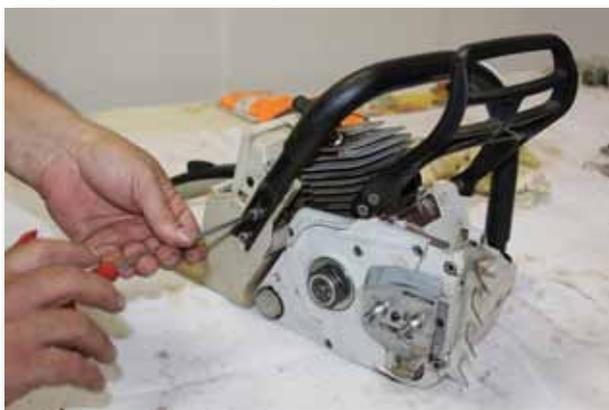
**5.15. Retire a luva de acoplamento do cilindro com a carcaça do tanque**
