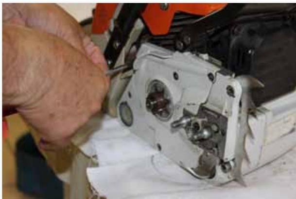
**4.1.13. Retire a tampa de proteção do sistema**
