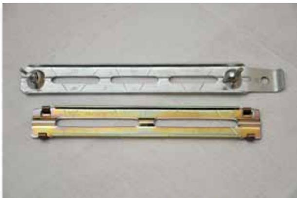
Calibrador de guia – Utilizado como limitador de profundidade no rebaixamento da guia.
