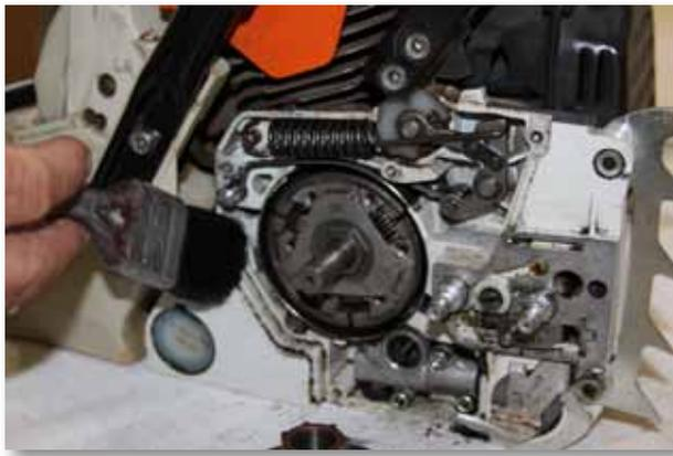
A limpeza é feita com auxílio de um pincel, querosene ou gasolina.
