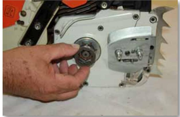
Coloque o rolete novo e, para montar, faça a operação inversa.
