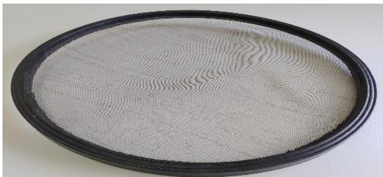
**Figura 22.** Peneira com malha para “areia de reboco”.
