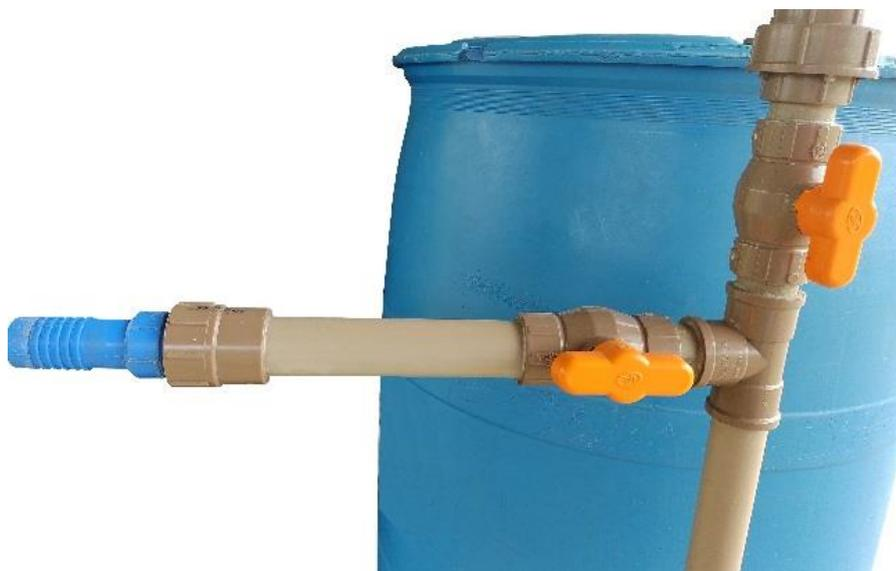
**Figura 8.** Sistema de descarga do biofertilizante.
