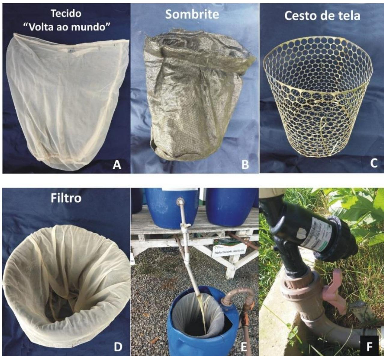
**Figura 26.** Montagem do sistema de filtração do biofertilizante para uso em gotejamento. A) Saco de tecido “volta ao mundo”. B) Saco de “sombrite”. C) Cesto de tela metálica. D) Filtro montado. E) Biofertilizante sendo filtrado. F) Filtro de sistema de gotejamento.
