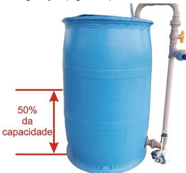
**Figura 23.** Nível máximo de produção do biofertilizante.
