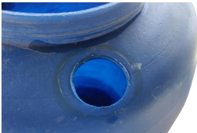
**Figura 14.** Furação superior de 50 mm, na bombona tipo “Azeitona”.
